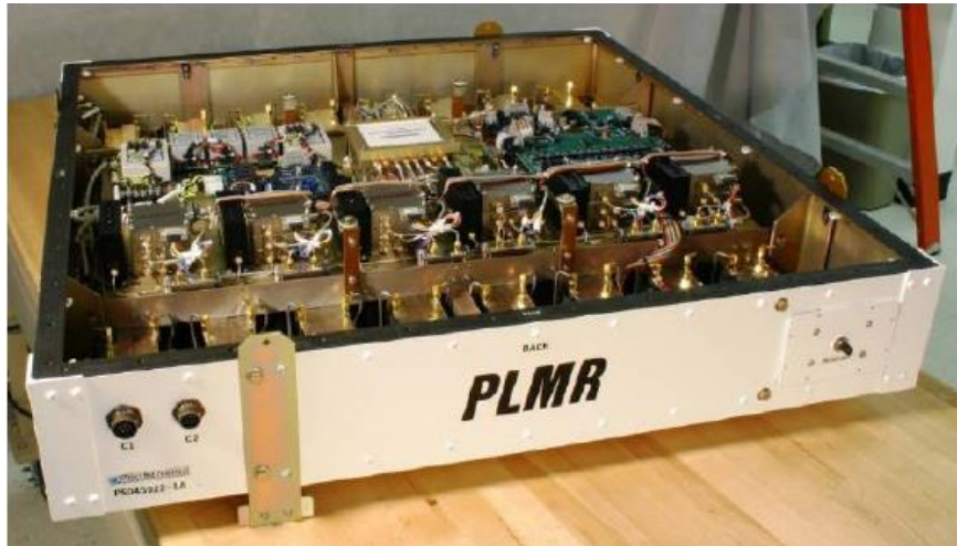
Fig. 3. Polarimetric L-band Multibeam Radiometer
